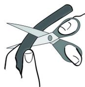
Das **robuste Gewebe** des Kabelschlauchs lässt sich schnell mit einer **Schere** auf jede gewünschte Länge **kürzen**.
